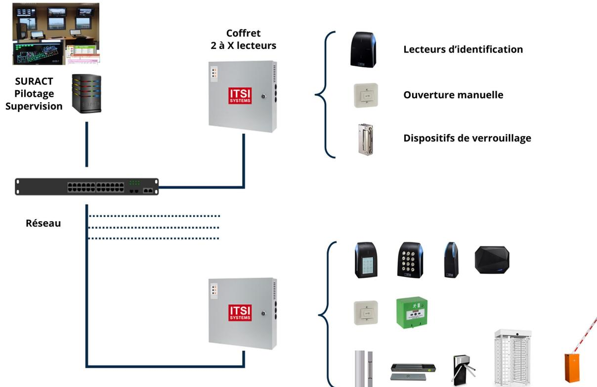
Grace à son logiciel puissant, évolutif et simple à utiliser, SURACT® possède toutes les fonctionnalités d'applications de contrôle d'accès centralisé tout en s'adaptant aux besoins et exigences de sécurité.
